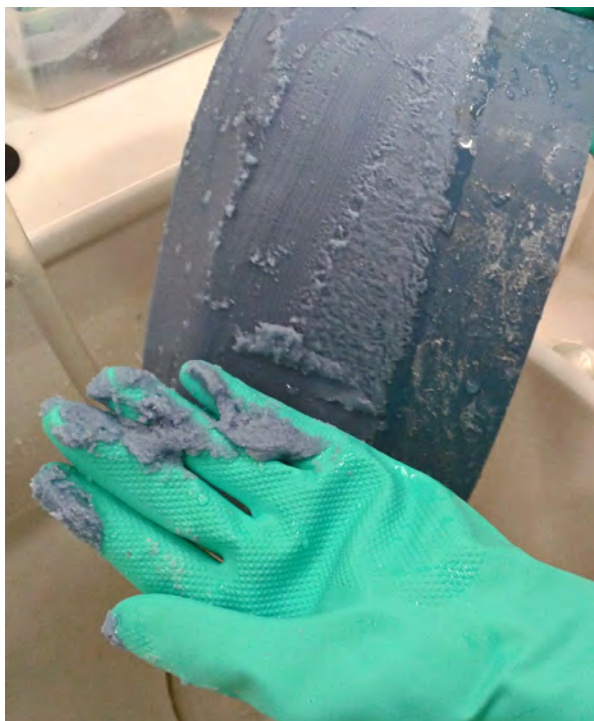
شکل ۱. لوله‌های PVC-U که حمله دی کلرو متان را نشان می‌دهند: الف) حمله به ناحیه پخی، اطراف کل محیط لوله؛ ب) حمله تعمیم یافته و انحلال برآیند آن در PVC، با تشکیل یک خمیر
