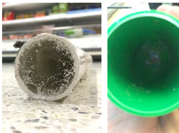
شکل ۲. دیواره داخلی Bio Pipe® (راست) ۱۲ ماه بعد از نصب، در مقابل: دیواره داخلی یک لوله استاندارد (چپ) ۶ ماه پس از تمیز کردن.
